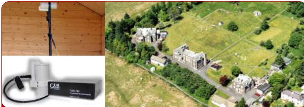
Magnetômetro Overhauser GSM-90 instalado na estação observatório British Geological Survey (BGS) em Eskdalemuir, Sul da Escócia.
