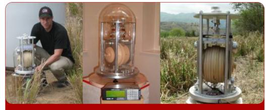
dIdD integra 3 sistemas de bobinas GSM-19FD, con sensor Overhauser cerrado y diseñado para aplicaciones de monitoreo en observatorio a largo plazo
