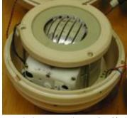
El revestimiento exterior es de plástico resistente al impacto. Una placa de soporte superior asegura de que no hay movimiento del sensor. El sensor de tamaño más pequeño tiene ventajas en términos de robustez (es decir, es más duradero que las generaciones anteriores con tamaño mayor, sensores cilíndricos).
